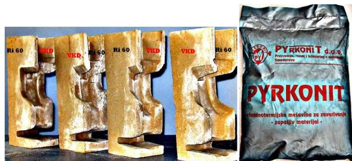
Slika 2. Kalupne polovice i AT smjesa za izradu prijelaznih zavara
