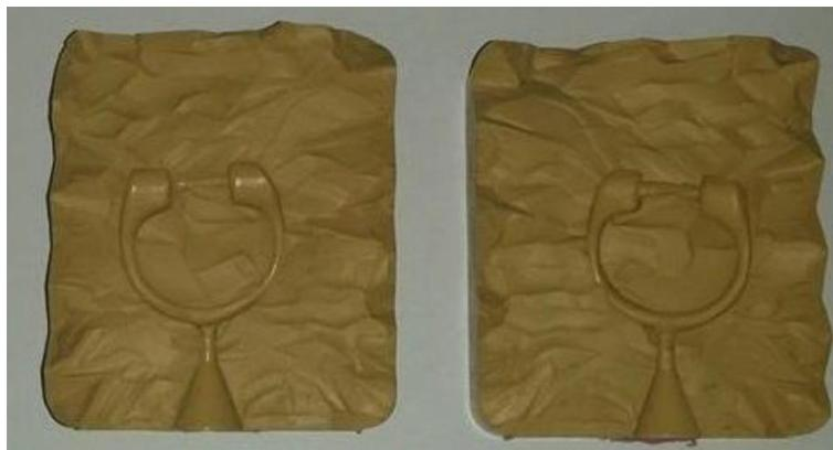
Slika 4. Otvoreni gumeni kalup za izradu modela
