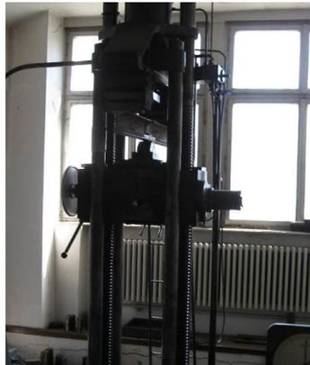
Slika 7. Ispitivanje zavarenog spoja na savijanje
