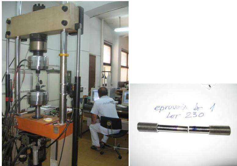
Slika 4. Ispitivanje vlačnih karakteristika i izgled epruvete nakon kidanja
