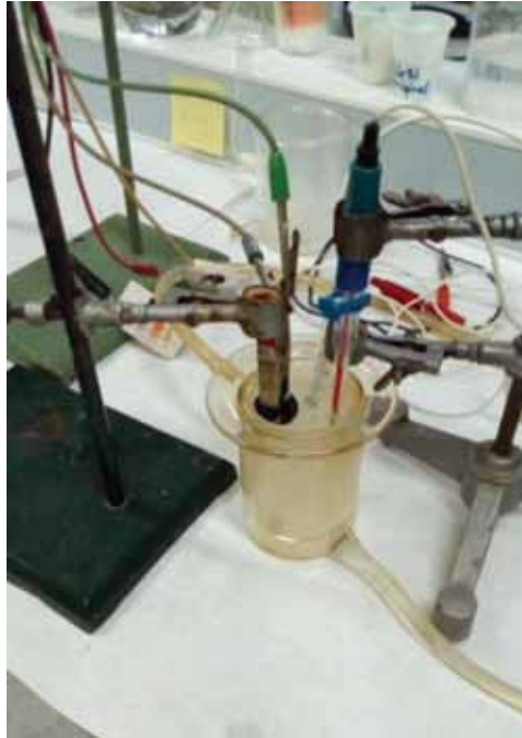
Slika 1. Troelektrodna staklena ćelija
